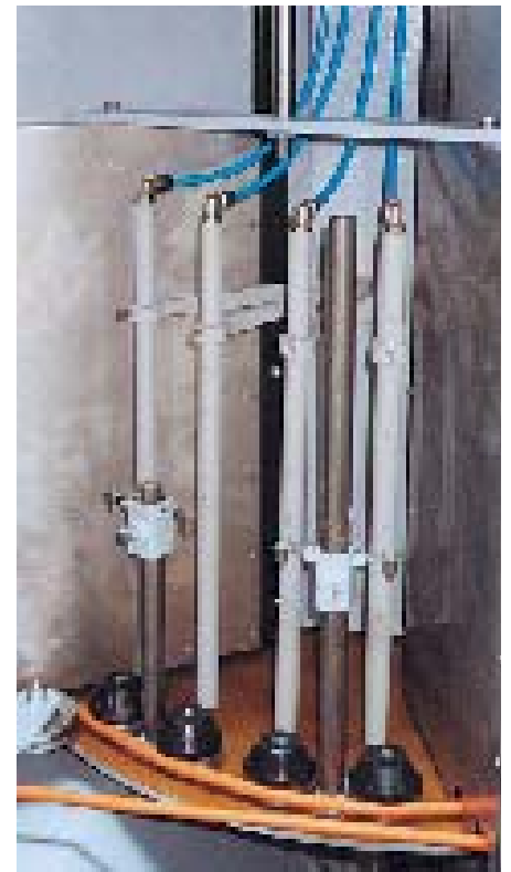
Abreinigungsstation mit Linearluftdüsen
