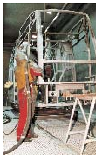
Strahlbetrieb im Strahlraum
