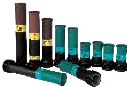
► Venturi-Hochleistungsstrahldüsen mit PU-Umantelung in verschiedenen Materialien wie z. B. Siliziumcarbid, Wolframcarbid oder Borcarbid mit Ø 3,0-12,5 mm lieferbar
