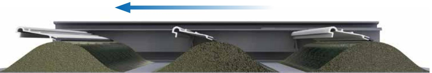
Beim Rückhub gleiten die Schubförderleisten über das Strahlmittel
