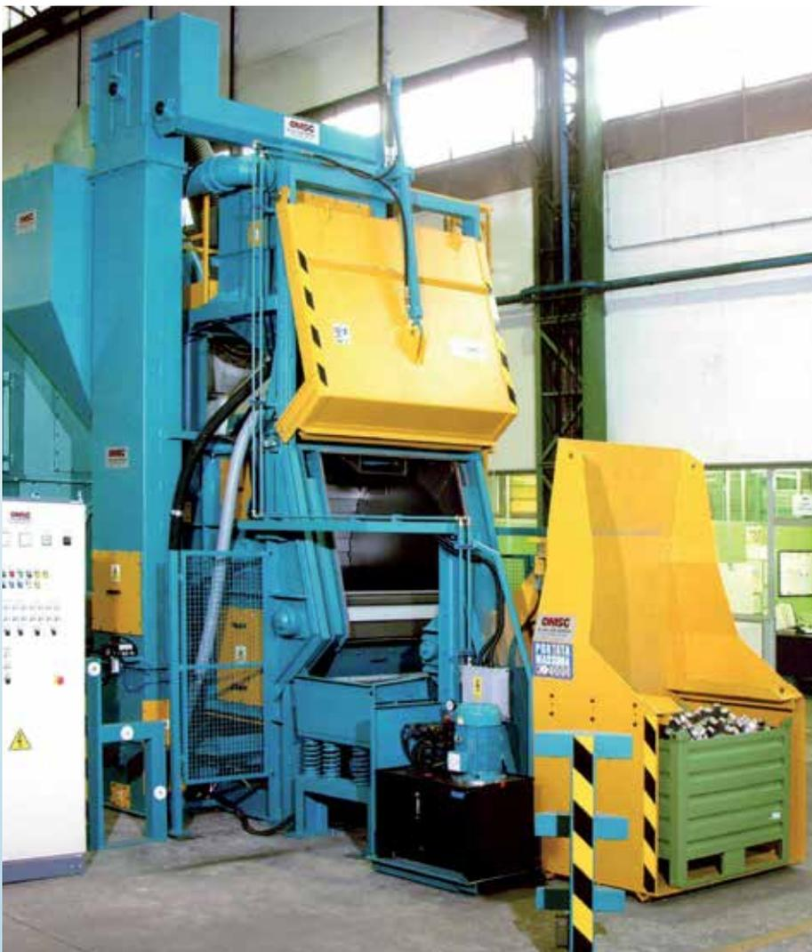
Standard-Stahlmuldenbandanlage mit Beladevorrichtung (Skip) und Vibro-Förderer
