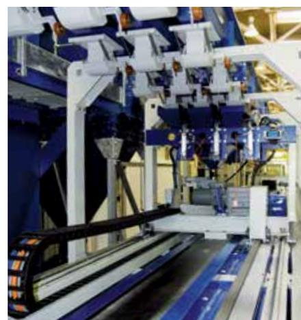
Automatisiertes Strahlmittelwechselsystem für 3 Medien
