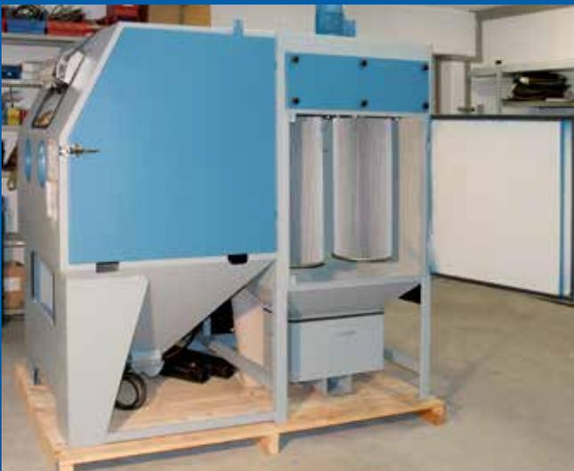
Compact 4+ Ansicht Filteranlage mit 2 Filterpatronen
