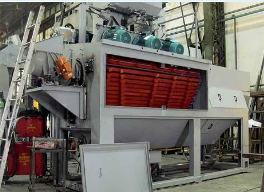
Assembling einer Durchlauf-Muldenband-Strahlanlage der Typenreihe Rotoflow 200
