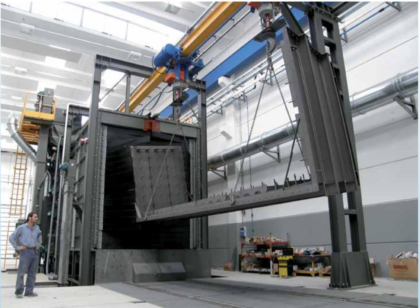
**Tunnelblast 20x25 mit synchron fahrenden Hubzügen**
