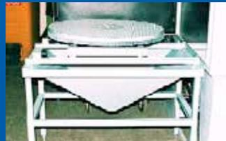
Drehtisch mit Ausfahrstrecke und Auffangtrichter
