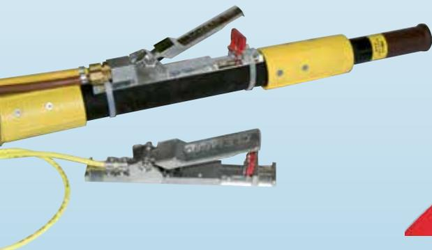
Sicherheits-Fernbedienungs-Hebel pneumatisch mit Zweischlauch-Sicherheitssystem oder elektrisch
