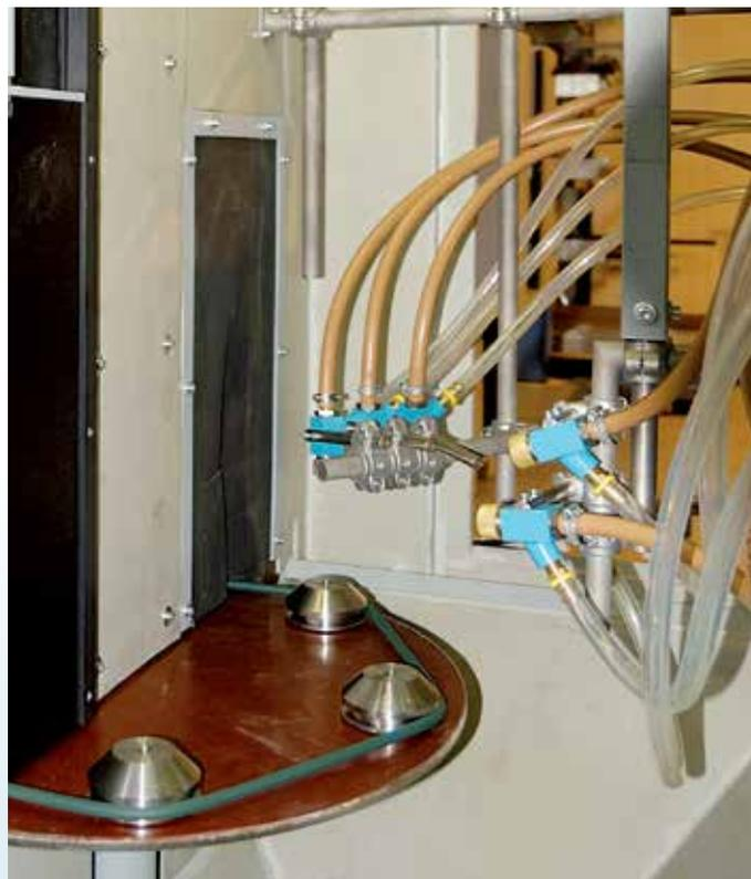
Innenansicht der Strahlkammer. Oszillierende und feststehende Düsen
