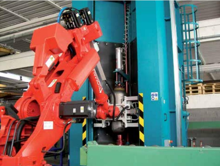
Boiler-Strahlanlage mit Roboterbeschickung
